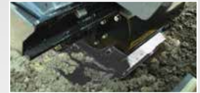
Piede di regolazione della profondità di scavo Foot for the adjustment of the excavation depth
