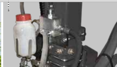
Motore idraulico per ogni gruppo di lame Hydraulic motor for each cutting disk group
